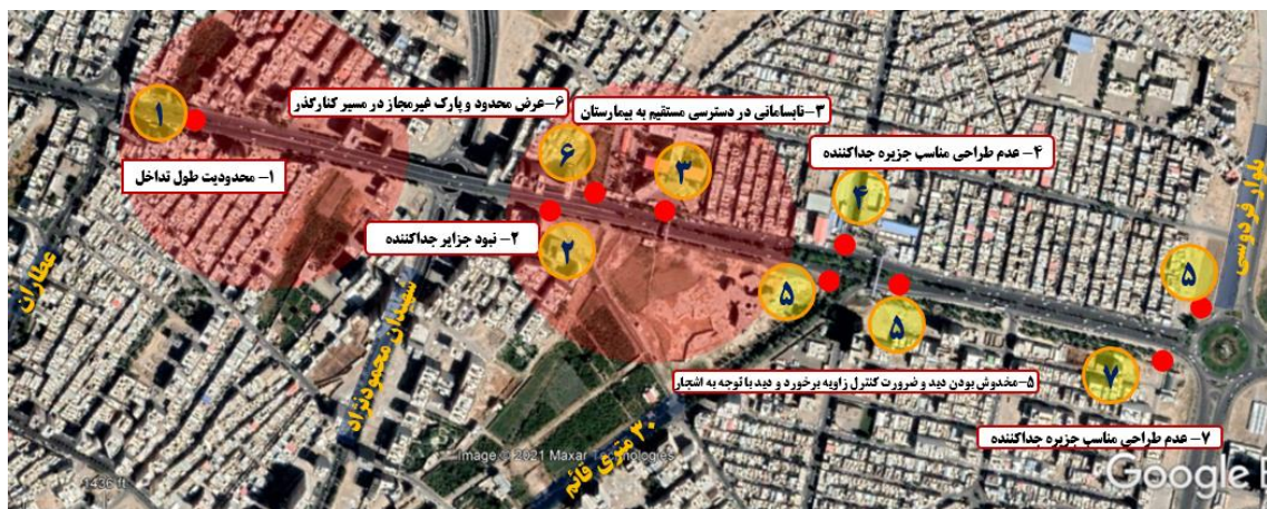
شکل ۱۳۰. نیازهای شناسایی شده اصلاح هندسی در محور جمهوری محدوده جنوب قمروود (حداقل تقاطع عطاران تا میدان نماز)
