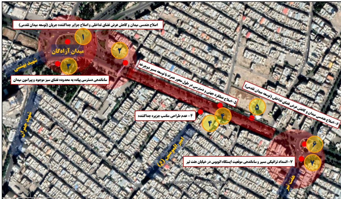
شکل ۱۲۱. نمایی از مسائل هندسی احصاء شده در طول محور نواب صفوی (حداصل میدان آزادگان-میدان شهرداری)
