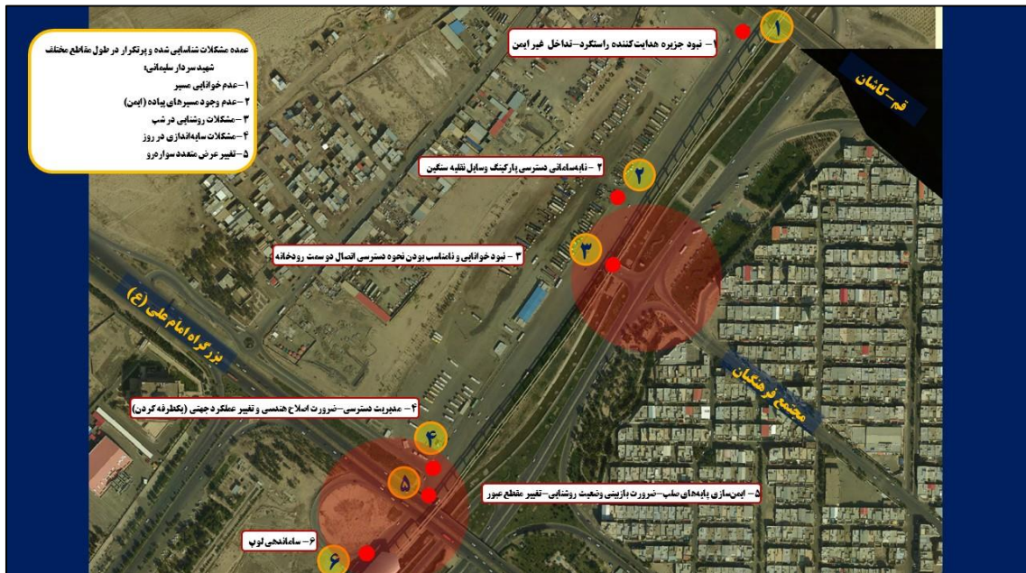
شکل ۱۴۲. نیازهای شناسایی شده اصلاح هندسی در محور شهید سردار سلیمانی پارت اول
