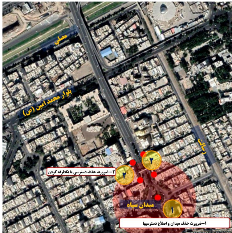
شکل ۱۲۸. نیازهای شناسایی شده اصلاح هندسی در محور جمهوری محدوده جنوب قمرود (حداصل مصلی تا میدان سپاه)
