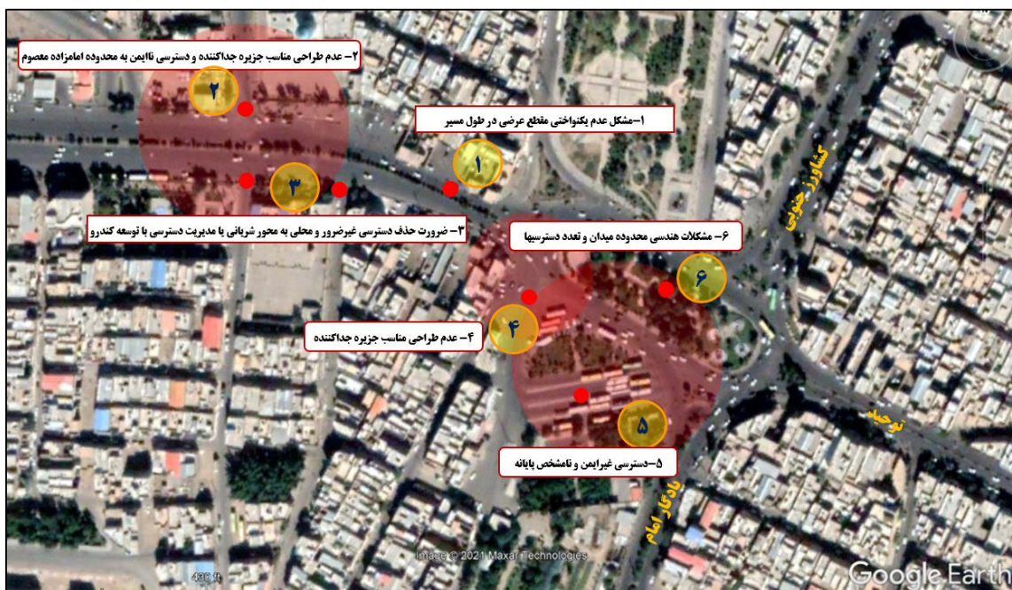
شکل ۱۱۷. مشکلات هندسی محور توحید در محدوده میدان نبوت (قطعه اول مسیر)
