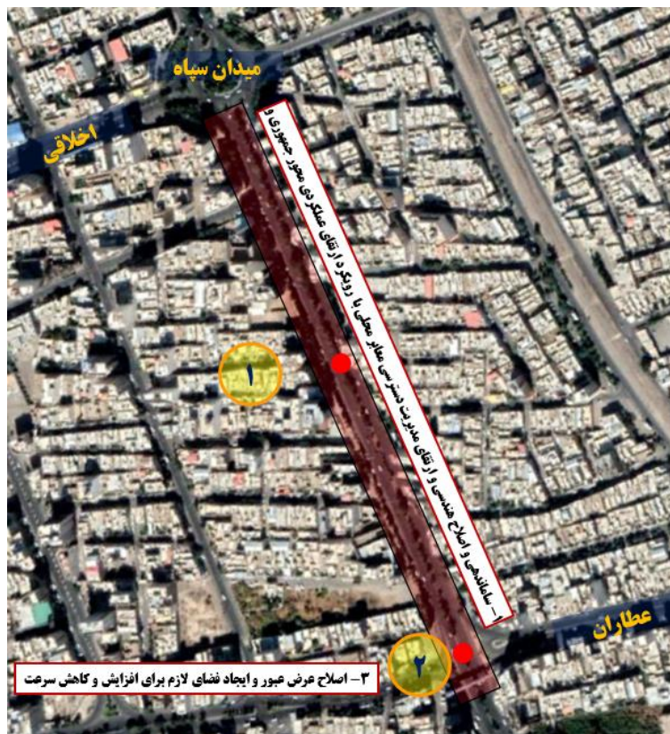
شکل ۱۲۹. نیازهای شناسایی شده اصلاح هندسی در محور جمهوری محدوده جنوب قمرود (حداصل میدان سپاه یا تقاطع عطاران)
